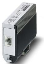
Protection antisurtension selon classe E<sub>A</sub> (CAT6<sub>A</sub>), pour Ethernet Gigabit (jusqu'à 10 Gbits/s), Token Ring, FDDI/CDDI, RNIS, DS1. Convient également pour la technologie Power over Ethernet (PoE++ / 4PPoE) en « mode A » et « mode B ». Adaptateur RJ45 avec câble de terre séparé et pied encliquetable de raccordement à la terre pour profilés NS 35.
