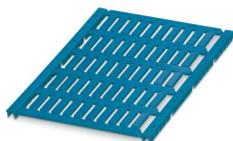
Repère pour conducteur, Plaque, bleu, vierge, repérable avec : TOPMARK NEO, LASER TOPMARK, BLUEMARK ID COLOR, BLUEMARK ID, BLUEMARK CLED, THERMOMARK PRIME, THERMOMARK CARD 2.0, THERMOMARK CARD, type de montage: insertion, plage de diamètre de câble: 0,6 ... 50 mm, surface utile: 15 x 4 mm, Nombre d'étiquettes: 50
