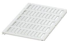
Repère pour conducteur, Plaque, blanc, vierge, repérable avec : TOPMARK NEO, LASER TOPMARK, BLUEMARK ID COLOR, BLUEMARK ID, BLUEMARK CLED, THERMOMARK PRIME, THERMOMARK CARD 2.0, THERMOMARK CARD, type de montage: insertion, plage de diamètre de câble: 0,6 ... 50 mm, surface utile: 15 x 4 mm, Nombre d'étiquettes: 50
