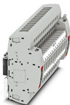
Connecteur de test, Détrompage de type C14 selon la norme allemande VDE, tension nominale: 400 V, nombre de connexions: 28, nombre de pôles: 14, type de raccordement: Raccordement vissé, 1er étage, Section de référence: 6 mm<sup>2</sup>, section : 0,2 mm<sup>2</sup> - 10 mm<sup>2</sup>, type de montage: Montage sur profilé, coloris: gris
