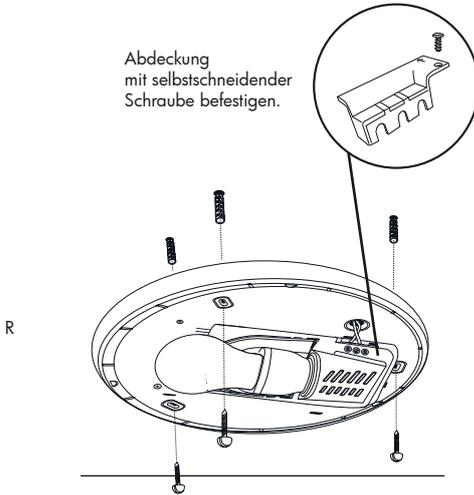
étirer la verrine par une légère rotation dans le sens inverse des aiguilles d'une montre. Passez le cordon d'alimentation dans le passage en caoutchouc à l'arrière du support. Marquer les endroits à percer au plafond ou sur le mur. Percer des trous appropriés et bien enfoncer les chevilles dans les forures. Fixer le support à l'aide des vis.
