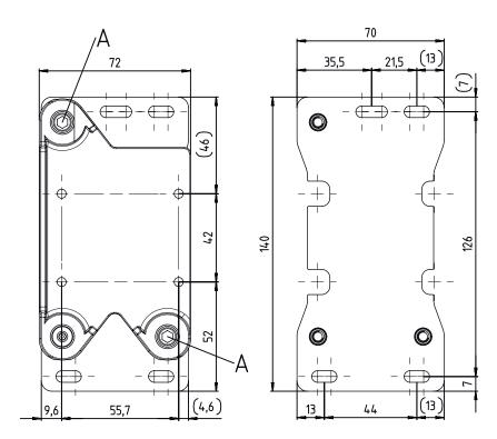
A Vis d'ajustage avec six pans creux, clé de 4
