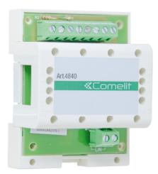
Distributeur de ligne pour installation vidéo. Permet de distribuer le signal sur 4 colonnes montantes. Ne nécéssite aucune alimentation. Système Simplebus 2. Dimensions :  $66 \times 85 \times 35$  mm (4 modules DIN).
