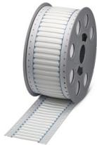
Gaine thermorétractable, Rouleau, blanc, vierge, repérable avec : THERMOMARK E.300 (D)/600 (D), THERMOMARK ROLLMASTER 300/600, THERMOMARK ROLL X1, THERMOMARK ROLL, THERMOMARK ROLL 2.0, THERMOMARK W, THERMOMARK X1.2, non perforé, type de montage: enfilage, plage de diamètre de câble: 1 ... 3,2 mm, surface utile: 60 x 5 mm, Nombre d'étiquettes: 2500
