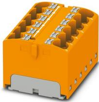
Bloc distributeur, pontage interne, tension nominale: 450 V, intensité nominale: 32 A, nombre de connexions: 12, type de raccordement: Raccordement Push-in, section : 0,2 mm<sup>2</sup> - 6 mm<sup>2</sup>, type de montage: collage, coloris: orange
