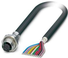
Connecteur d'appareil face arrière, Universel, 12-pôles, PVC/PVC, noir RAL 9005, blindé, connecteur femelle, droit, M12-SPEEDCONNEC, détrompage: A, sur extrémité libre, Montage face arrière, M16 x 1,5, Raccordement de câble, longueur de câble: 1 m, 0,14 mm<sup>2</sup>, PVC noir, Produit de remplacement selon RoHS II sans exception 6c (Pb < 0,1 %) référence : 1239765
