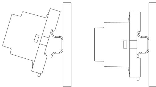
**FR** L'appareil est conçu pour être installé sur un panneau électrique. Les bornes de connexion seront cachées.
