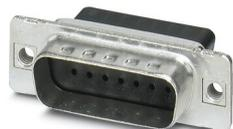
Porte-contacts D-SUB, taille Shell 2, pour 15 contacts de signalisation, type de contact mâle, pour le raccordement serti, droit, fixation au moyen d'un filetage M3, pour cadre de montage VS-15-...
