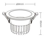
Diamètre de perçage : Ø80-85mm
