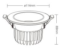
Diamètre de perçage : Ø95-100mm
