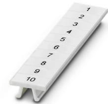
Ruban de repérage ZB, Rubans, blanc, repéré, impression transversale: numérotation continue 1 ... 10, 11 ... 20, etc. jusqu'à 91 ... 100, type de montage: encliquetage, pour bloc de jonction au pas de : 5,08 mm, surface utile: 10,5 x 5,15 mm, Nombre d'étiquettes: 10
