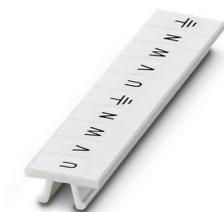
Ruban de repérage ZB, Rubans, blanc, repéré, impression longitudinale: U, V, W, N, GND, U, V, W, N, GND, type de montage: encliquetage, pour bloc de jonction au pas de : 5,08 mm, surface utile: 10,5 x 5,15 mm, Nombre d'étiquettes: 10
