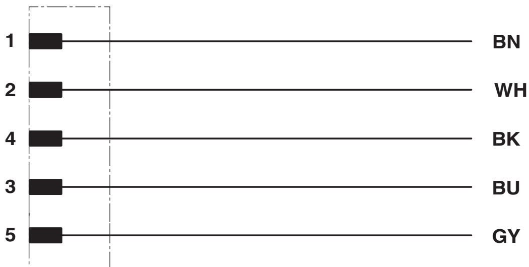
Schéma de connexion
