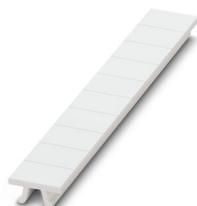
Ruban de repérage ZB, Rubans, blanc, impression selon les indications du client, type de montage: encliquetage dans la rainure de repérage élevée, pour bloc de jonction au pas de : 8,3 mm, surface utile: 10,5 x 8,3 mm
