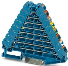
Connecteurs sous-répartiteurs, tension nominale: 250 V, intensité nominale: 8 A, type de raccordement: Raccordement Push-in, 1., 2., 3., 4., 5., 6., 7. und 8. Etage, Section de référence: 1,5 mm<sup>2</sup>, section : 0,14 mm<sup>2</sup> - 2,5 mm<sup>2</sup>, montage: NS 35/7,5, NS 35/15, coloris: bleu
