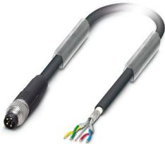
Câble préconfectionné pour bus, INTERBUS, 4-pôles exempt d'halogène, blindé, connecteur mâle droit M8, détrompage: A, sur extrémité libre, longueur de câble: 15 m
