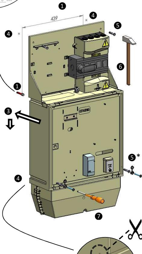
① Percer dans le support les 2 trous de fixation haut à un  $\varnothing 8$  et entraxe de 439mm.
