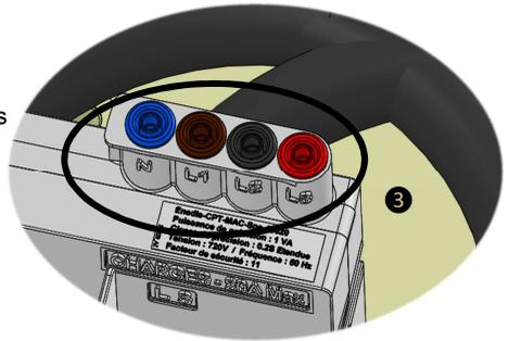
③ Plot de charges Ø 4mm (les extrémités sont raccordées à l'interrupteur sectionneur). Ces plots permettent de connecter une charge de 20A max pour vérifier le fonctionnement du compteur. A utiliser lors de la mise en service de l'installation ou pour les opérations de maintenance.
