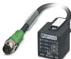
Câble pour capteurs/actionneurs, 3-pôles exempt d'halogène, connecteur mâle droit M12 SPEEDCONNec, détrompage: A, sur Connecteur de vanne A, avec 1 LED, câblé avec Diode zéner, longueur de câble: 0,6 m
