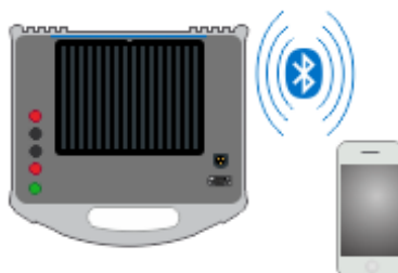
Image 5.5 : Connexion de l'appareil Euro Z 800 V au logiciel aMESM
