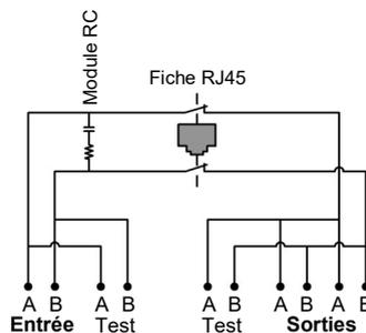
**DTIP RJ45 encastrable** avec module RC et protection parafoudre intégrés
