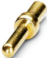
Contact à sertir, Mâle, tournés, diamètre de contact: 2 mm, zone de sertissage: 0,75 mm<sup>2</sup> ... 1 mm<sup>2</sup>, Produit de remplacement selon RoHS II sans exception 6c (Pb < 0,1 %) référence : 1238326
