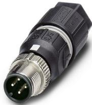
Connecteur, Universel, 4-pôles, connecteur mâle droit M12 SPEEDCONNEC, détrompage: A, Raccordement autodénudant, matériau de la molette: Zinc moulé sous pression, nickelé, diamètre extérieur du câble 4 mm ... 8 mm
