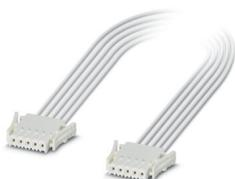
Connecteurs mâles pour C.I. câblés / Câble de connexion avec 2 connecteurs mâles pour C.I., courant de référence: 6 A, longueur de câble: Longueur au choix (0,1 ... 3,0 m), Tête 1: 5-pôles, pas: 2,5 mm, Raccordement à sertir, Connecteur femelle, Coloris: blanc, Type de câble: Toron individuel, PVC, 22 AWG, blanc, Tête 2: 5-pôles, pas: 2,5 mm, Raccordement à sertir, Connecteur femelle, Coloris: blanc, Type de câble: Toron individuel, PVC, 20 AWG, blanc, Toron individuel, PVC, 22 AWG, blanc
