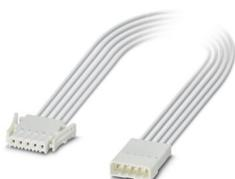
Connecteurs mâles pour C.I. câblés / Câble de connexion avec 2 connecteurs mâles pour C.I., courant de référence: 6 A, longueur de câble: Longueur au choix (0,1 ... 3,0 m), Tête 1: 5-pôles, pas: 2,5 mm, Raccordement à sertir, Connecteur femelle, Coloris: blanc, Type de câble: Toron individuel, PVC, 22 AWG, blanc, Tête 2: 5-pôles, pas: 2,5 mm, Raccordement à sertir, Mâle, Coloris: blanc, Type de câble: Toron individuel, PVC, 20 AWG, blanc, Toron individuel, PVC, 22 AWG, blanc
