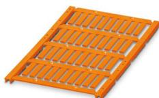
Repère pour conducteur, Planche, orange, vierge, repérable avec : TOPMARK NEO, LASER TOPMARK, BLUEMARK ID COLOR, BLUEMARK ID, BLUEMARK CLED, THERMOMARK PRIME, THERMOMARK CARD 2.0, THERMOMARK CARD, type de montage: insertion, plage de diamètre de câble: 0,6 ... 22 mm, surface utile: 18 x 4 mm, Nombre d'étiquettes: 40
