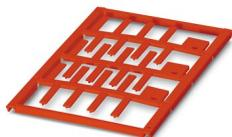
Repère pour conducteur, Planche, rouge, vierge, repérable avec : BLUEMARK ID COLOR, BLUEMARK ID, BLUEMARK CLED, PLOTMARK, CMS-P1-PLOTTER, type de montage: insertion, plage de diamètre de câble: 0,6 ... 22 mm, surface utile: 18 x 4 mm, Nombre d'étiquettes: 24
