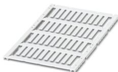
Repère pour conducteur, Plaque, blanc, vierge, repérable avec : TOPMARK NEO, LASER TOPMARK, BLUEMARK ID COLOR, BLUEMARK ID, BLUEMARK CLED, THERMOMARK PRIME, THERMOMARK CARD 2.0, THERMOMARK CARD, type de montage: insertion, plage de diamètre de câble: 0,6 ... 22 mm, surface utile: 18 x 4 mm, Nombre d'étiquettes: 40
