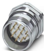
M23, Embases paroi avant, série: RC, droit, blindé: oui, Verrouillage à vis, Nombre de pôles: 16, Sens de rotation: standard, type de contact: Mâle, Cône de soudage, Joint axial, Fixation centrale, détrompage: N
