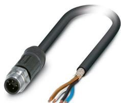
Câble pour capteurs/actionneurs, 4-pôles exempt d'halogène, blindé, connecteur mâle droit M12, détrompage: A, câblé avec déconnecté, sur extrémité libre, longueur de câble: 2 m, pour applications extérieures, avec molette inox
