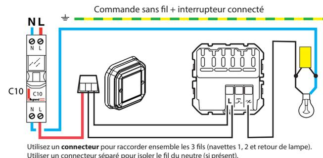
**Cas du remplacement d'un Va-et-vient par un Poussoir + variateur**
