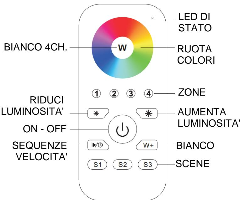
Ogni telecomando può gestire 4 zone, ad ogni zona può essere associato un numero illimitato di ricevitori nei limiti delle distanze massime di trasmissione.
