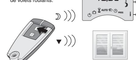
Cette commande peut être annulée sur le CALYBOX, en appuyant sur l'une des touches des zones ou en tournant la molette.
