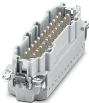
Eléments de contact, nombre de pôles: 24+2 PE, taille: B24, nombre de raccordements par pôle: 1, Mâle, Raccordement Push-in, 500 V, 16 A, 0,14 mm<sup>2</sup> ... 2,5 mm<sup>2</sup>, application: Puissance, montage Click-in sans outils
