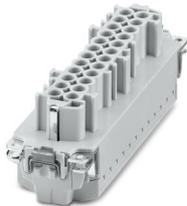
Eléments de contact, nombre de pôles: 24+2 PE, taille: B24, nombre de raccordements par pôle: 1, Connecteur femelle, Raccordement Push-in, 500 V, 16 A, 0,14 mm<sup>2</sup> ... 2,5 mm<sup>2</sup>, application: Puissance, montage Click-in sans outils
