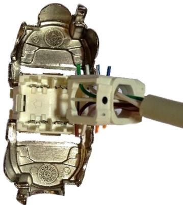
3. Replacer le bloc de connexion (*sens unique grâce au détrompeur*) après avoir fait une coupe nette sur les 8 fils.
