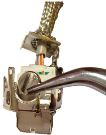
4. Enlever l'opercule pour le passage de câble (arrière ou côté), puis refermer les 2 clapets du bloc RJ45.
