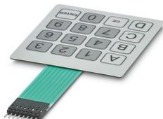
Clavier à membrane adhésif, technologie des pistes conductrices en argent, 16 touches, estampé, 3 couleurs, câble de raccordement : 62 mm, avec connecteur femelle à sertir, pas 2,54 mm, température de fonctionnement : -20 °C ... 70 °C
