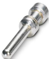
Contact à sertir, diamètre de contact: 2,5 mm, tournés, Mâle, matériau de contact: Alliage de cuivre, sans plomb, surface des contacts: plaqué argent, section raccordable: 0,5 mm<sup>2</sup> ... 0,5 mm<sup>2</sup>, AWG 20
