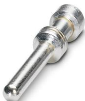
Contact à sertir, diamètre de contact: 2,5 mm, tournés, Mâle, matériau de contact: Alliage de cuivre, surface des contacts: plaqué argent, section raccordable: 2,5 mm<sup>2</sup> ... 2,5 mm<sup>2</sup>, AWG 14
