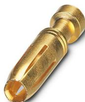
Contact à sertir, diamètre de contact: 2,5 mm, tournés, Connecteur femelle, matériau de contact: Alliage de cuivre, sans plomb, surface des contacts: doré, section raccordable: 4 mm<sup>2</sup> ... 4 mm<sup>2</sup>, AWG 12
