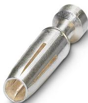
Contact à sertir, diamètre de contact: 2,5 mm, tournés, Connecteur femelle, matériau de contact: Alliage de cuivre, sans plomb, surface des contacts: plaqué argent, section raccordable: 0,5 mm<sup>2</sup> ... 0,5 mm<sup>2</sup>, AWG 20
