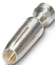
Contact à sertir, diamètre de contact: 2,5 mm, tournés, Connecteur femelle, matériau de contact: Alliage de cuivre, surface des contacts: plaqué argent, section raccordable: 4 mm<sup>2</sup> ... 4 mm<sup>2</sup>, AWG 12
