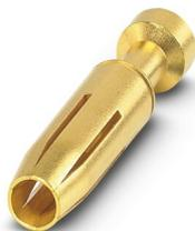
Contact à sertir, diamètre de contact: 2,5 mm, tournés, Connecteur femelle, matériau de contact: Alliage de cuivre, surface des contacts: doré, section raccordable: 4 mm<sup>2</sup> ... 4 mm<sup>2</sup>, AWG 12
