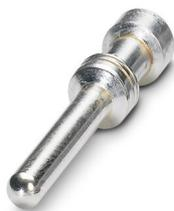
Contact à sertir, diamètre de contact: 2,5 mm, tournés, Mâle, matériau de contact: Alliage de cuivre, surface des contacts: plaqué argent, section raccordable: 4 mm<sup>2</sup> ... 4 mm<sup>2</sup>, AWG 12
