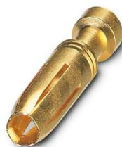
Contact à sertir, diamètre de contact: 2,5 mm, tournés, Connecteur femelle, matériau de contact: Alliage de cuivre, sans plomb, surface des contacts: doré, section raccordable: 1,5 mm<sup>2</sup> ... 1,5 mm<sup>2</sup>, AWG 16
