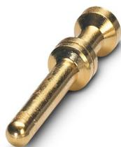
Contact à sertir, diamètre de contact: 2,5 mm, tournés, Mâle, matériau de contact: Alliage de cuivre, sans plomb, surface des contacts: doré, section raccordable: 1 mm<sup>2</sup> ... 1 mm<sup>2</sup>, AWG 18
