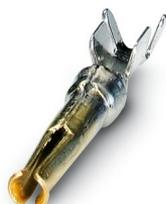
Contact à sertir, pour isolants pour contacts D-SUB avec densité de contact standard, contact femelle, section de raccordement AWG 24 ... 20, estampé, doré
