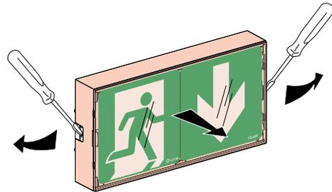
Les accumulateurs doivent être remplacés lorsque le bloc autonome ne satisfait plus à sa durée assignée de fonctionnement.
