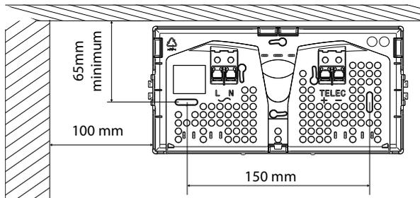
Fixation possible sur des trous existants avec un entraxe différent grâce aux alvéoles transparentes. Il est possible de fixer le fond sans l'avoir au préalable percé, il suffit de visser directement dans les alvéoles
