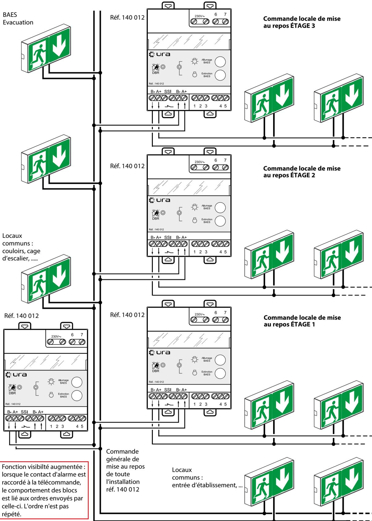
Fonction visibilité augmentée : lorsque le contact d'alarme est raccordé à la télécommande, le comportement des blocs est lié aux ordres envoyés par celle-ci. L'ordre n'est pas répété.
