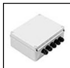
S.2402 ALIMENTATION ELECTRONIQUE NON GRADABLE IN BOX 60W 230Vac/24Vdc IP55 Dimensions: 260 x 240 x 100 mm En entrée: N° 2 presse étoupes PG 11 En sortie: N° 5 presse étoupes PG 11 CLASSE ELETRIQUE II SELV Le nombre maximum d'appareils dépend de la somme des puissances unitaires de l'appareil. L'UTILISATION DU DÉCHARGEUR À SURTENSION S.2499 EST RECOMMANDÉE POUR CHAQUE BALLAST ÉLECTRONIQUE QUI DOIT ÊTRE INSTALLÉ À UNE DISTANCE MAXIMALE DE 10m DE CELUI-CI.
