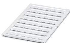
Repères pour blocs de jonction, à commander : sous forme de planche, blanc, impression selon les indications du client, type de montage: encliquetage dans la rainure de repérage plate, pour bloc de jonction au pas de : 6,2 mm, surface utile: 5,6 x 5,1 mm, Nombre d'étiquettes: 80
