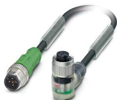
Câble pour capteurs/actionneurs, 5-pôles exempt d'halogène, connecteur mâle droit M12, détrompage: A, avec 3 LED, câblé avec déconnecté, sur Connecteur femelle coudé M12, détrompage: A, avec 3 LED, longueur de câble: 10 m, Variante client
