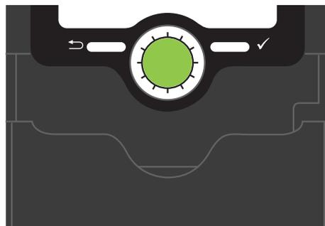
Le régulateur se commande avec les 2 touches et l'actionneur rotatif (Lightwheel®) situés sous l'écran :
