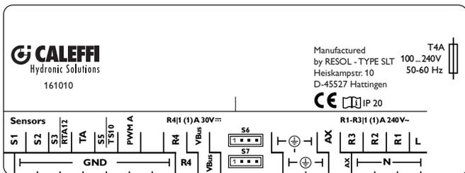
Le **raccordement au réseau** se réalise par le biais des bornes suivantes :
