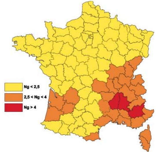
Dans le cas de sites qui ne sont pas soumis à une obligation d'installation, quelques règles simples permettent d'évaluer l'intérêt de l'installation de parafoudres et leur choix en fonction du coût ou du rôle du matériel à protéger, de l'historique du site en matière de dégâts dus à la foudre et de sa situation (niveau kéraunique local, valeur de terre et composition du terrain, structures environnantes).
