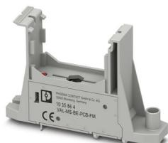
Élément d'embase monocanal pour parafoudres de type I et type II, séries VAL-MS, pour systèmes d'alimentation isolés et mis à la terre jusqu'à 1 500 V DC et 690 V AC, pour installation compacte sur circuit imprimé à contact de télésignalisation intégré
