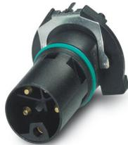
Porta-contatos, Puissance, 5-pôles, Connecteur mâle, droit, M12, détrompage: L, Montage circuits imprimés, Raccordement soudé THR, L'article est sans plomb, conformément à la directive RoHS II, sans exception 6c (Pb < 0,1 %)
