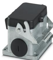
Embase en saillie B48, avec étrier longitudinal, matériau: Aluminium coulé sous pression, résistant à l'eau de mer, matériau du couvercle de protection: PA, nombre de sorties: 2, latérale, 2x Pg29, hauteur: 99 mm, presse-étoupe: sans, capot de protection: oui, Standard
