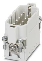
Élément de contact, nombre de pôles: 10+PE, taille: D15, nombre de raccordements par pôle: 1, Mâle, Raccordement Push-in, 250 V, 16 A, 0,14 mm<sup>2</sup> ... 2,5 mm<sup>2</sup>
