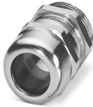
Presse-étoupe, matériau du raccordement vissé: Laiton, nickelé, diamètre extérieur du câble 6 mm ... 12 mm, blindage: non, filetage de raccordement: M20 x 1,5, coloris: argenté, avec joint torique
