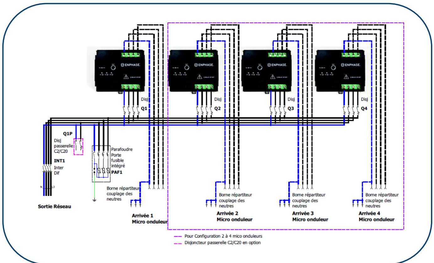
Figure 31 : Schéma de principe coffret AC TRI 1 QR TRI pour micro-onduleur ENPHASE 3 variantes (de 2 à 4 QR TRI) avec option prise
