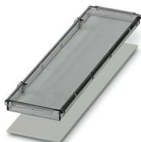
Boîtier électronique sur rail DIN pour l'utilisation dans les répartiteurs d'installation suivant la norme DIN 43880, couvercle pivotant transparent, plombable, Avec cadre inséparable, largeur: 161,6 mm, hauteur: 45 mm, profondeur: 8 mm, coloris: transparent/gris clair (7035)
