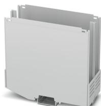
Boîtier électronique sur rail DIN, Partie inférieure du boîtier avec pied métallique de verrouillage, Etage 1 : fentes d'aération, largeur: 50,1 mm, hauteur: 122,5 mm, profondeur: 108,35 mm, coloris: gris clair (7035), connexion transversale: Connecteur de bus sur rail DIN (en option), nombre de pôles connecteur transversal: 8
