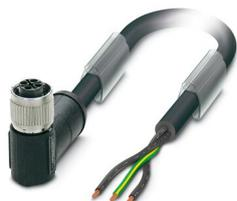
Conducteur de puissance, 3-pôles, extrémité libre, sur Connecteur femelle coudé M12, détrompage: S, longueur de câble: 20 m, pour courant alternatif jusque 16 A/230 V
