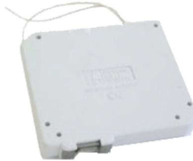
Détecteur à fil pour volets équipé d'un système d'analyse du signal provenant de deux contacts à l'intérieur du détecteur. Connexion par câble à 4 conducteurs (alimentation et contact d'alarme). Utilisable également avec les émetteurs sans fil art. RFMGAB et RFMAGW. Contact NF en état de veille et NO en état d'alarme. Tension d'alimentation 2,8 - 13,8 Vcc.
