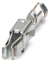
Contact femelle modulaire, à enfiler dans le capot MSTBC après le sertissage du conducteur, pour conducteur de 0,2 à 0,5 mm<sup>2</sup>
