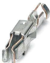
Contact femelle modulaire, à enfile dans le capot MSTBC après sertissage du conducteur, pour conducteurs de 1,5 à 2,5 mm<sup>2</sup>, sous forme de ruban
